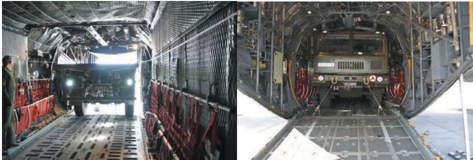
Rys. 1.2. Widok z praktycznej próby załadunku pojazdu wojskowego do samolotu Hercules C-130
