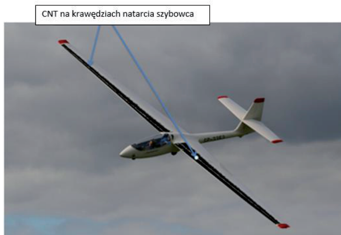
Rys. 7. Wizualizacja szybowca z CNT na krawędziach natarcia [materiały własne]
