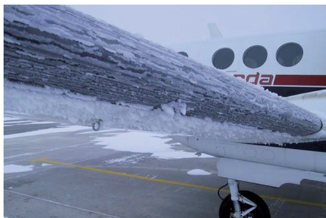
Rys. 5. Obładzenie krawędzi natarcia skrzydła samolotu Beechcraft King Air [21]
