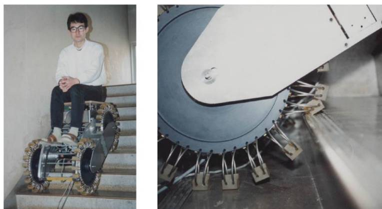
Rys. 9. Konstrukcja o sprężystych kołach tzw. Terrain-AdaptiveQuadru-Track (TAQT) [12]
